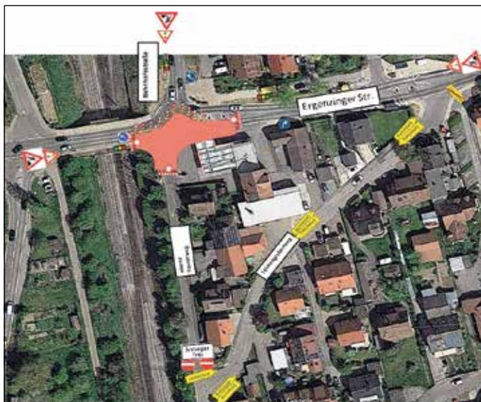
Wegen eines Gewährleistungsfalls muss schadhaftes Pflaster am Mini-Kreisel bei der ESSO Tankstelle ausgebaut werden. In Kalenderwoche 30 wird deshalb eine Ampelschaltung eingerichtet. Im Zuge dieser Maßnahme wird die Fläche in der Mitte des Kreisels farblich abgegrenzt ausgestaltet. Damit soll die Aufmerksamkeit und die Verkehrssicherheit erhöht werden. Nachfolgender Bauablauf ist vorgesehen:
